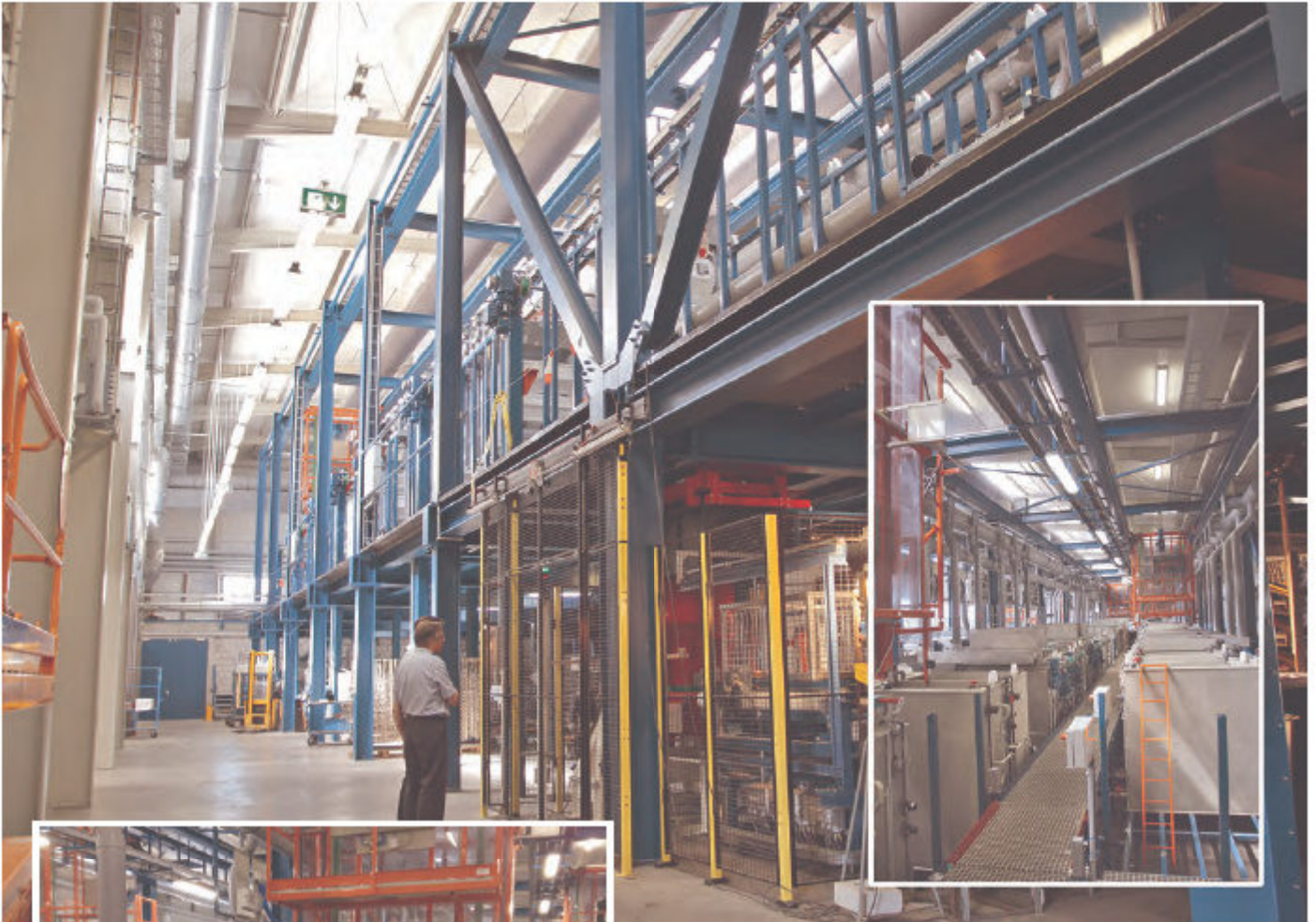
Eine der größten Anlagen Europas zur chemischen Abscheidung von Nickel arbeitet in Weiterstadt mit einem neuen innovativen Konzept über zwei Etagen
